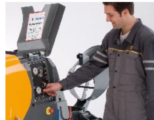
Le tableau de commande est ordonné et „sobre“. Une trappe pratique et robuste sert de protection contre les salissures.
