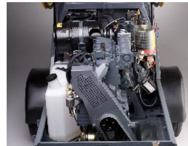
Le nouveau moteur diesel est installé en ligne. L'ensemble est ainsi bien rangé et accessible.
